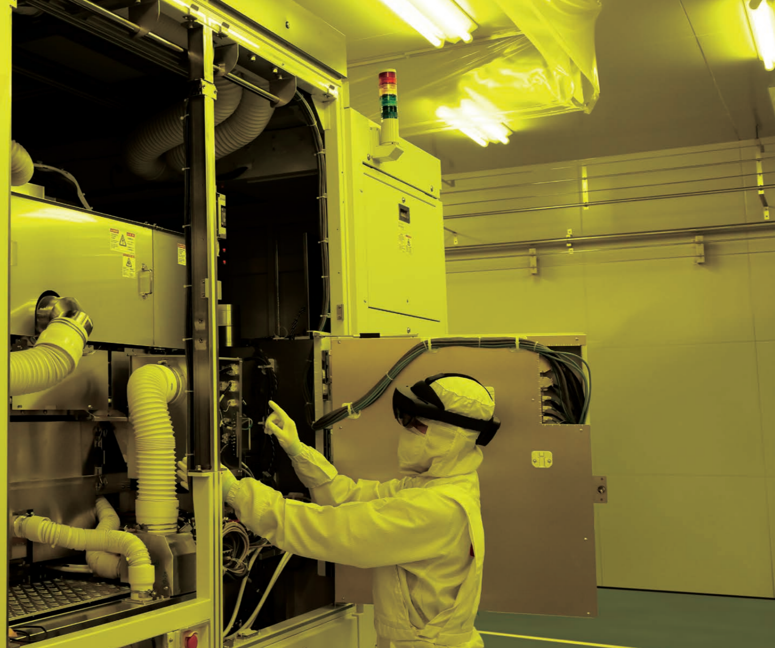
Interventi di manutenzione eseguiti seguendo le istruzioni di un ologramma di un manuale, visualizzato attraverso un display montato sulla testa
