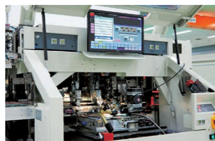
I die bonder di Canon Machinery garantiscono alta velocità e precisione elevata
