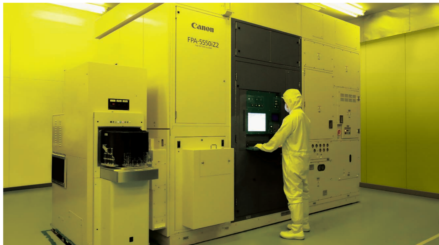
Lo stepper i-line utilizzato per produrre memorie, sensori di immagine e molto altro
