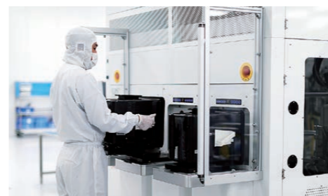
El equipo de erosión catódica de Canon ANELVA deposita una película uniforme a nanoescala al vacío
