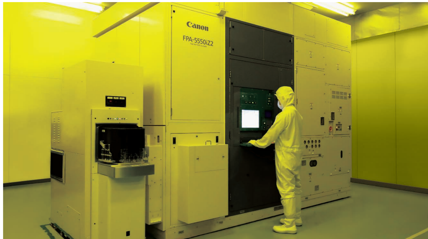
El sistema i-line utilizado para fabricar memorias, sensores de imagen, etc.
