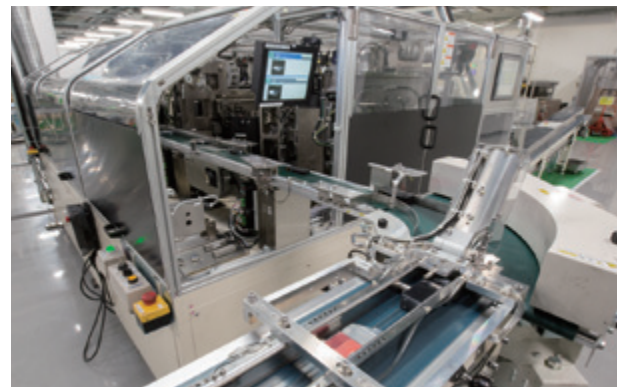
インクカートリッジリサイクルの自動化ライン「CARS-I」
