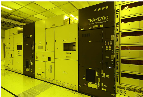
東芝メモリで稼働するナノインプリント半導体製造装置
