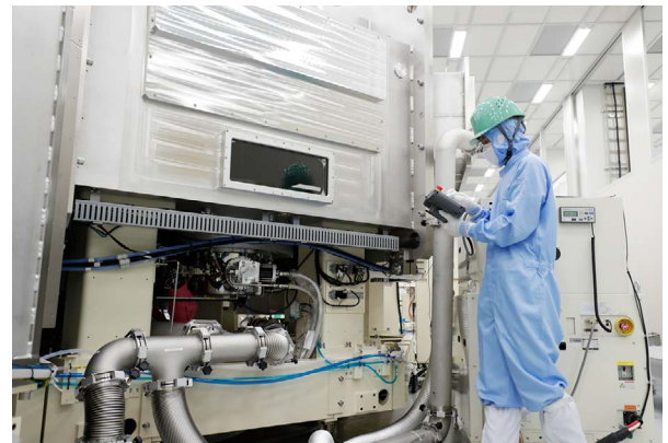
キヤノントッキで開発・製造する有機ELディスプレイ製造装置
