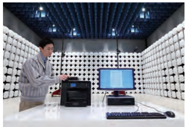
電波暗室における製品の放射電波測定
