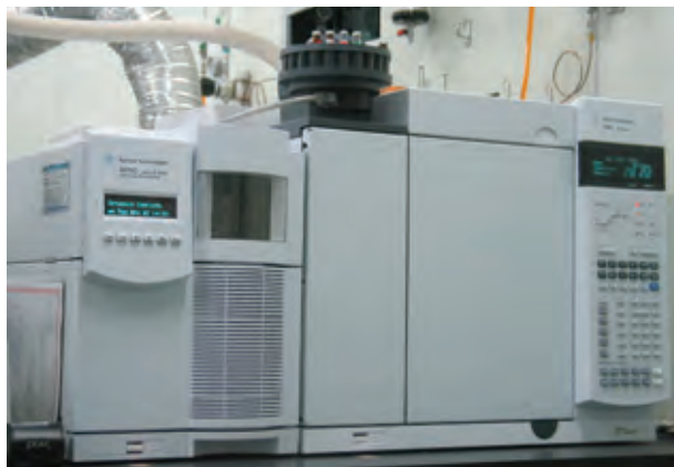
製品から放出される化学物質を測定するガスクロマトグラフ質量分析計
