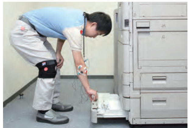
操作時の筋肉への負荷を測定する試験
