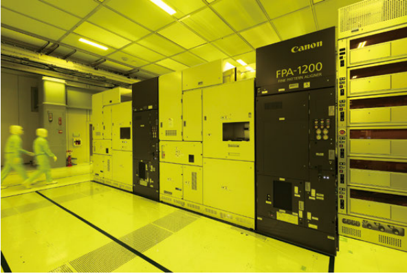
開発が進められているナノインプリント半導体製造装置
