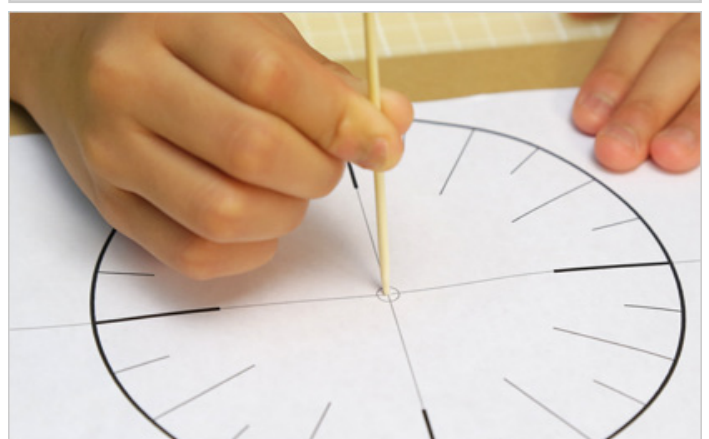
段ボールにはり付けた時刻盤の中心に穴を開け、竹ひごを通します。正確に直角に合わせ、竹ひごを盤面の表と裏から洗濯バサミではさみ、テープで固定します。
