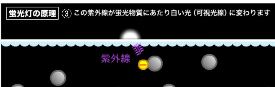
蛍光灯の両端にある電極に電圧を加えると電極のフィラメントが加熱され、電子が放出されます。ガラス管の中には水銀原子が入っており、管の内側一面には蛍光物質(けいこうぶっしつ)が塗られています。
