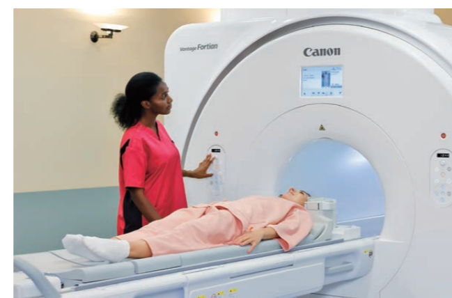
ディープラーニング ※2 を活用し画像ノイズを低減。静音も強みのMRI装置
