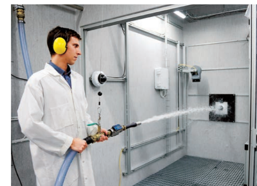
アクシスで行われているネットワークカメラの堅牢性テスト
