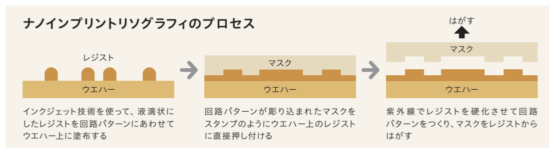
ナノインプリントリソグラフィで一括形成した微細で複雑な構造
