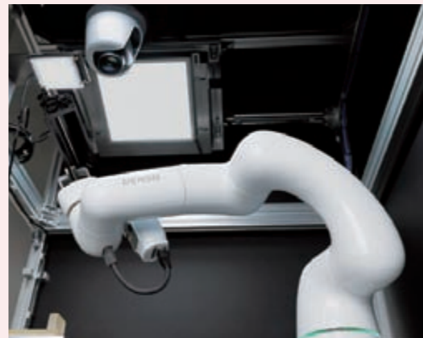
分析网络摄像机拍摄的图像(左上)并指导机器人
