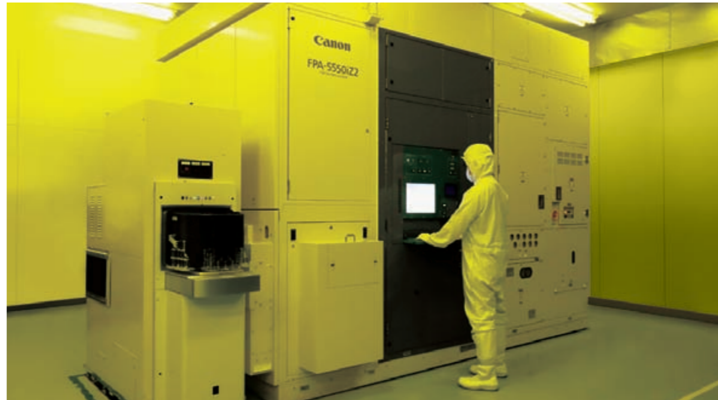
用于生产存储器和图像传感器等各种半导体器件的i-line光刻机
