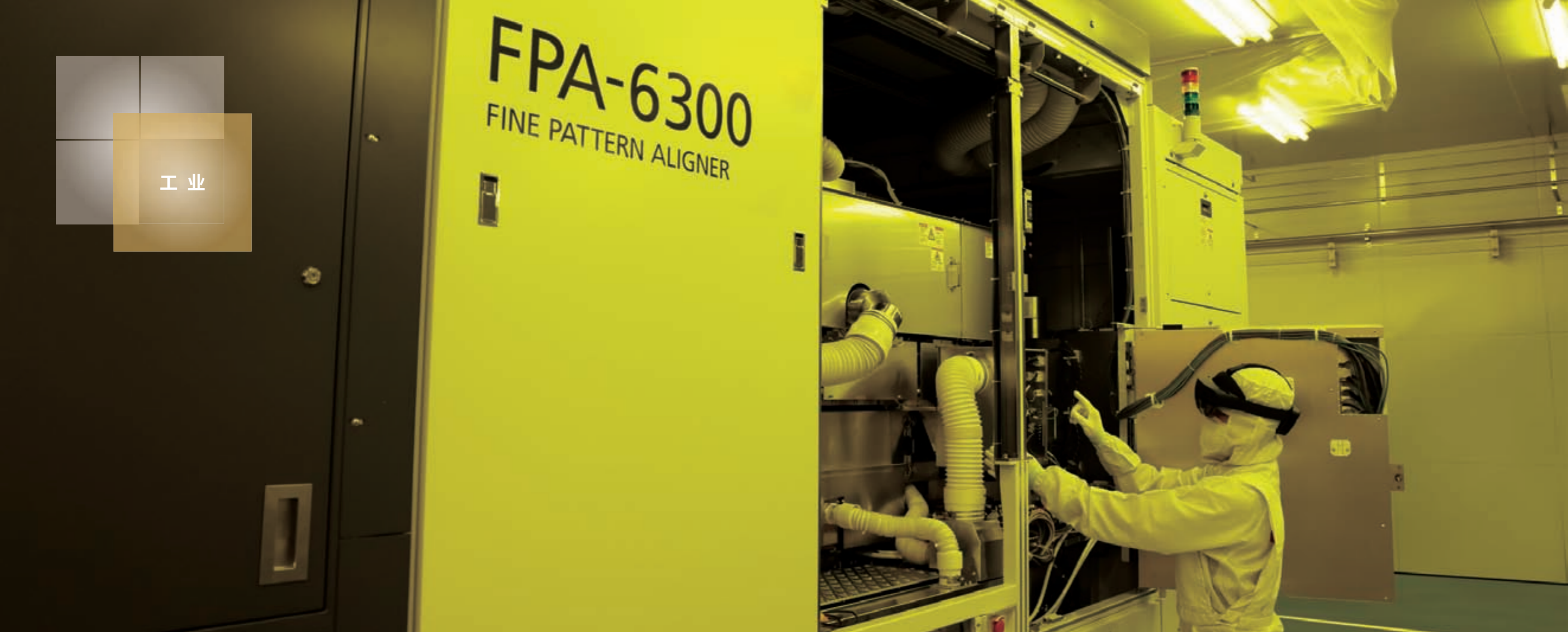
一边查看在头戴式显示器 (HMD) 上投影为全息图的程序手册，一边执行维护作业
