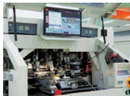
高速、高精度接合晶粒的佳能机械产固晶机
