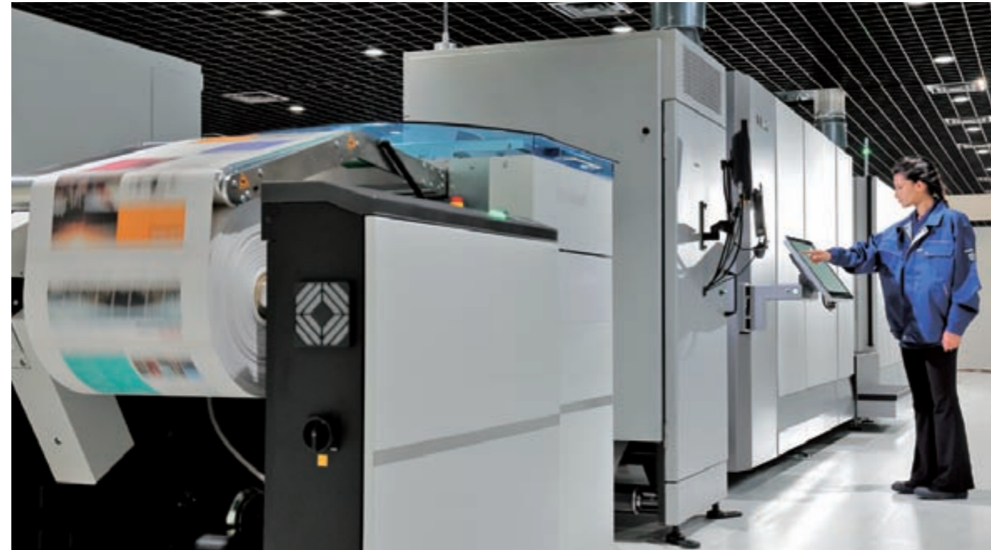
实现超高速和高画质数码印刷的连续纸印刷系统
