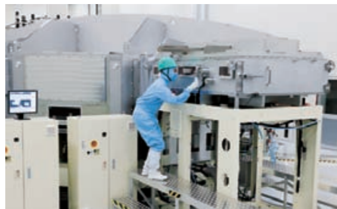
佳能特机生产的OLED面板制造设备
