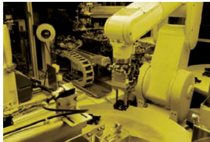
网络摄像机(左上)高精度检查生产状态
