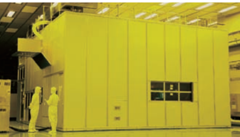
平板显示器（FPD）光刻机将显示器的电路曝光到玻璃基板上
