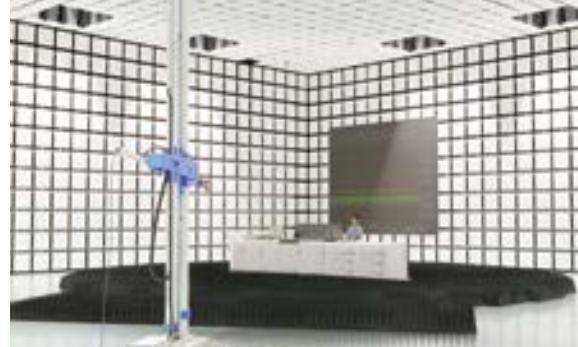
大型電波暗室における製品の放射電波測定
