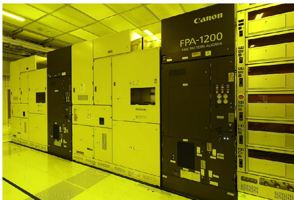
メモリーメーカーで量産化に向け検証中のナノインプリント半導体製造装置
