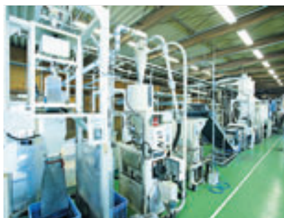
自動トナーカートリッジリサイクルプラント (キヤノンエコロジーインダストリー)
