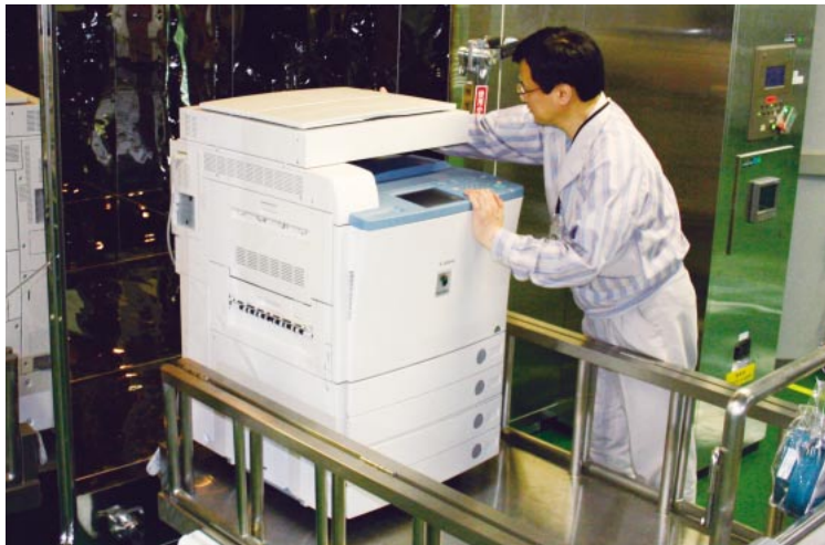
デジタル複合機における放散化学物質の測定試験
