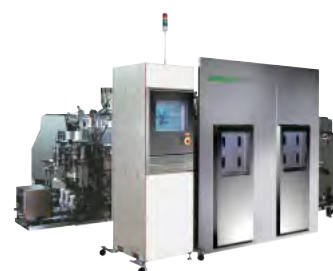
超高密度HDD磁気ヘッド生産用スパッタ装置
