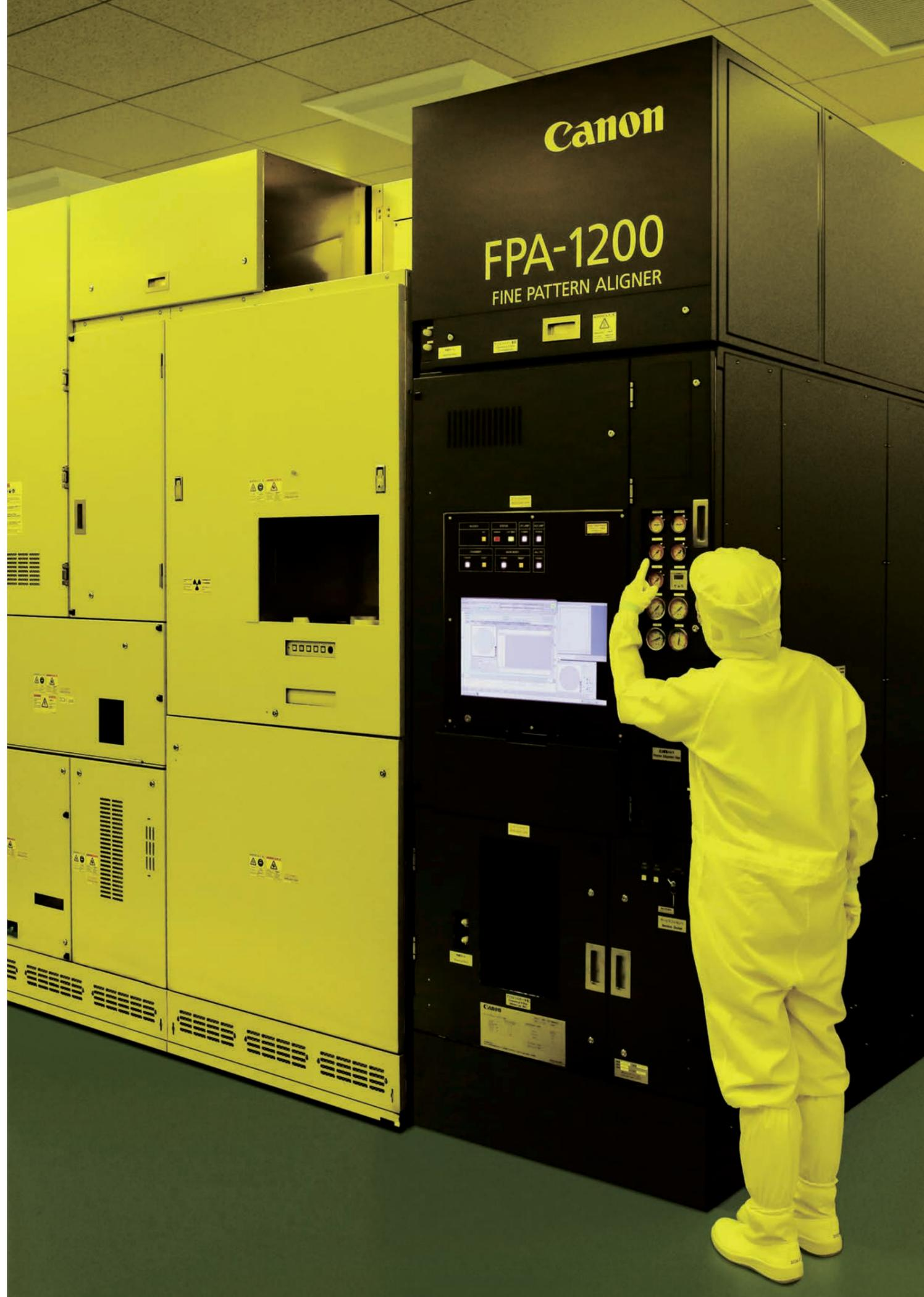
纳米压印半导体制造设备
