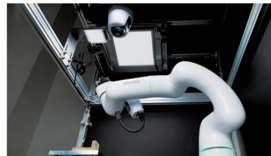
Une caméra réseau surveille un processus de contrôle qualité
