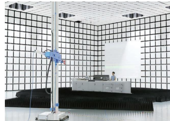
Qualitätstests mit einem kommerziellen Digitaldrucksystem in einem schalltoten Raum, der nicht durch elektromagnetische Störungen beeinträchtigt wird.
