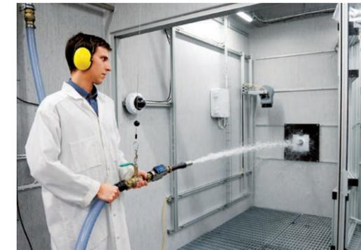
Testen der Haltbarkeit von Netzwerk-Kameras bei Axis.
