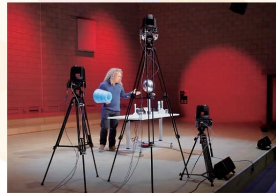
Le videocamere remote si muovono secondo le istruzioni dell'operatore che gestisce la videocamera principale
