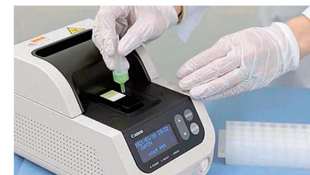
Una soluzione di analisi point-of-care: sistema di test antigenico rapido per SARS-CoV
