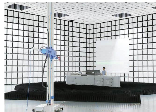
Test di qualità su una stampante digitale commerciale eseguiti in una camera anecoica che non risente di interferenze elettromagnetiche
