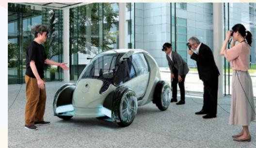
Las imágenes generadas por ordenador a tamaño natural (CG) pueden mostrarse en un entorno realista a través de una pantalla montada en gafas (HMD).
