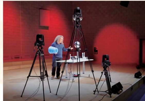
Las cámaras remotas se mueven según las instrucciones del operador de la cámara principal.
