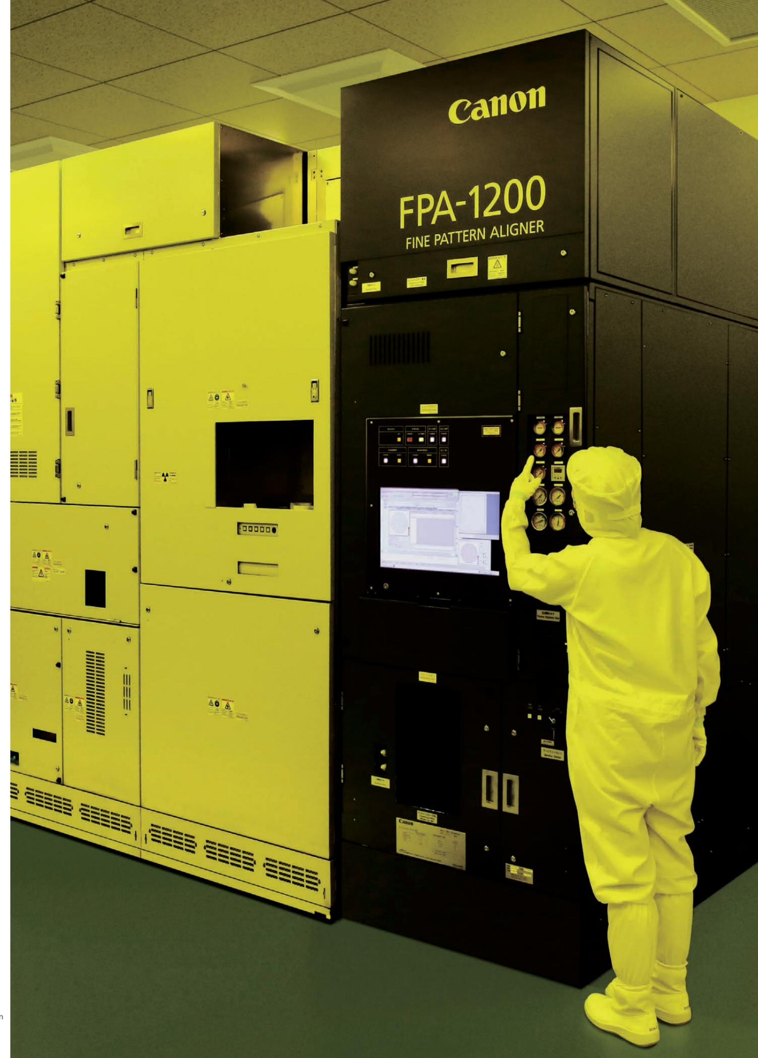
El sistema de fabricación de semiconductores por nanoimpresión FPA-1200NZ2C3 se lanzó en octubre de 2023
