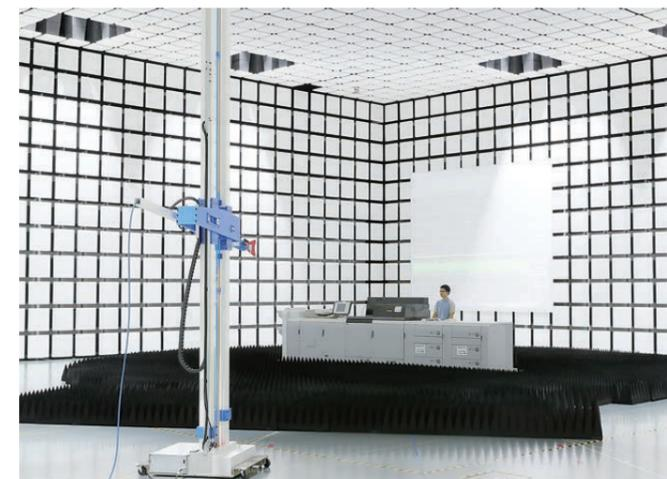
Pruebas de calidad en una impresora digital comercial realizadas en una cámara anecoica que no se ve afectada por interferencias electromagnéticas
