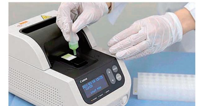
El sistema de pruebas rápidas de antígenos del SARS-CoV es un ejemplo de prueba en el punto de atención
