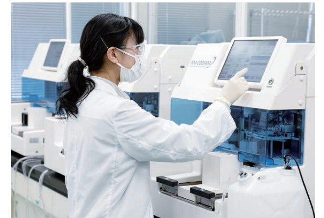
Automatisiertes biochemisches Analysegerät, das Probenuntersuchungen zur Unterstützung der Früherkennung von Darmkrebs und anderen Erkrankungen durchführt
