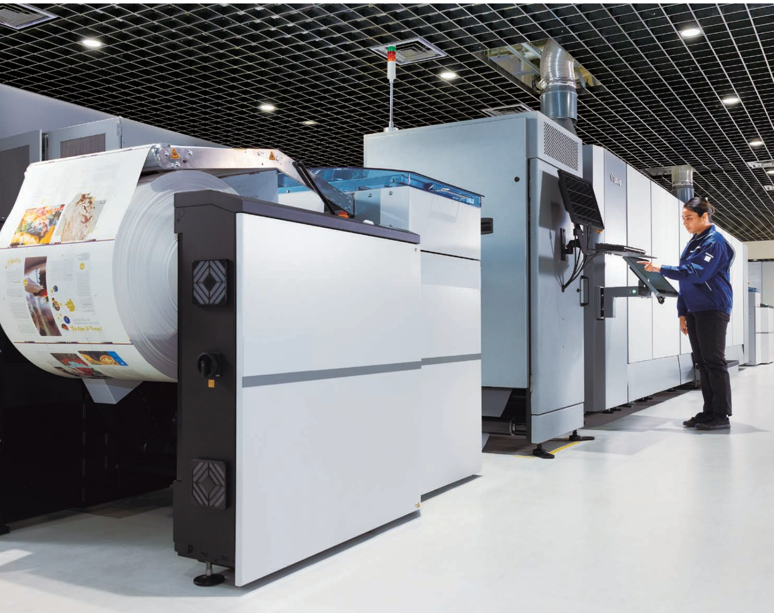
Ein Endlosdrucksystem für extrem hohe Geschwindigkeit und Digitaldruck in hoher Qualität
