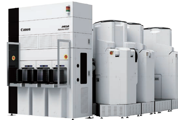
Die modulare Sputteranlage von Canon ANELVA bietet Flexibilität bei der Konfiguration
