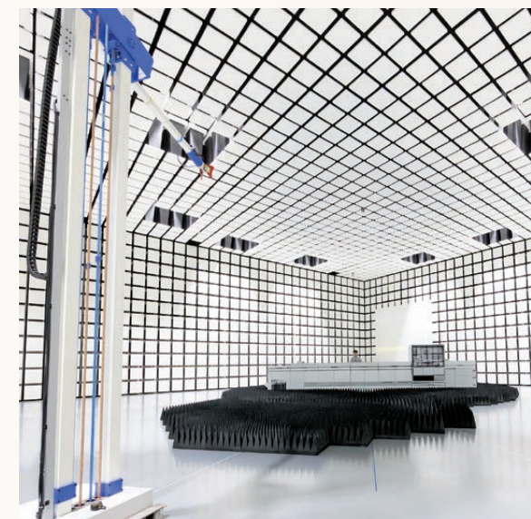
Qualitätstests bei einem kommerziellen Digitaldrucksystem in einem schalldichten Raum, der nicht durch elektromagnetische Störungen beeinträchtigt wird
