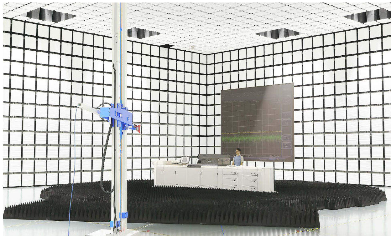
大型製品の試験を実施できる日本最大規模の電波暗室(→P116)
