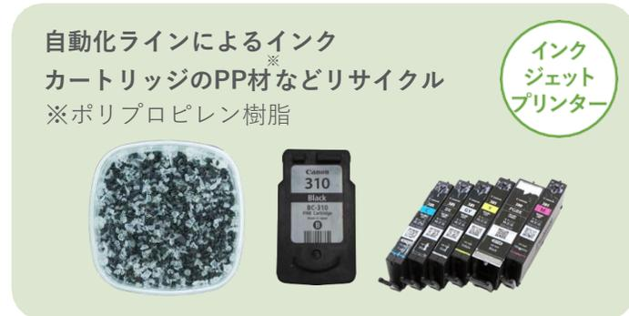
市場から回収されたキヤノン製品や消耗品を自社の再生拠点で分別・粉碎・再ペレット化<sup>※</sup>して、トナーカートリッジ等の成型材料として活用
