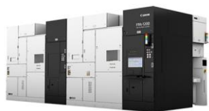
ナノインプリント半導体製造装置 「FPA-1200 NZ2C」
