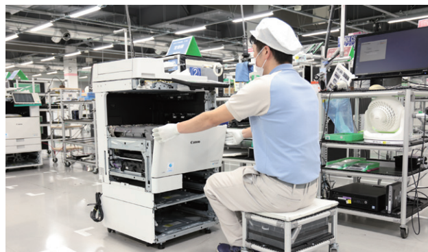
使用済みの複合機を再利用できるようにするリマニュファクチャリング
