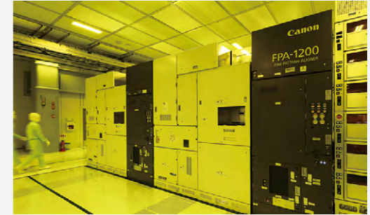
キオクシア株式会社で量産性の検証を行う ナノインプリント半導体製造装置
