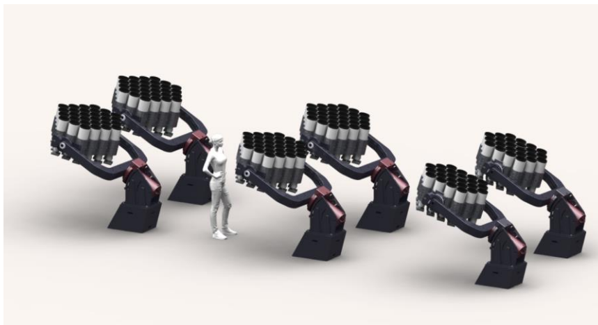
168本のレンズを配列した「Dragonfly Telephoto Array」の完成予想図
