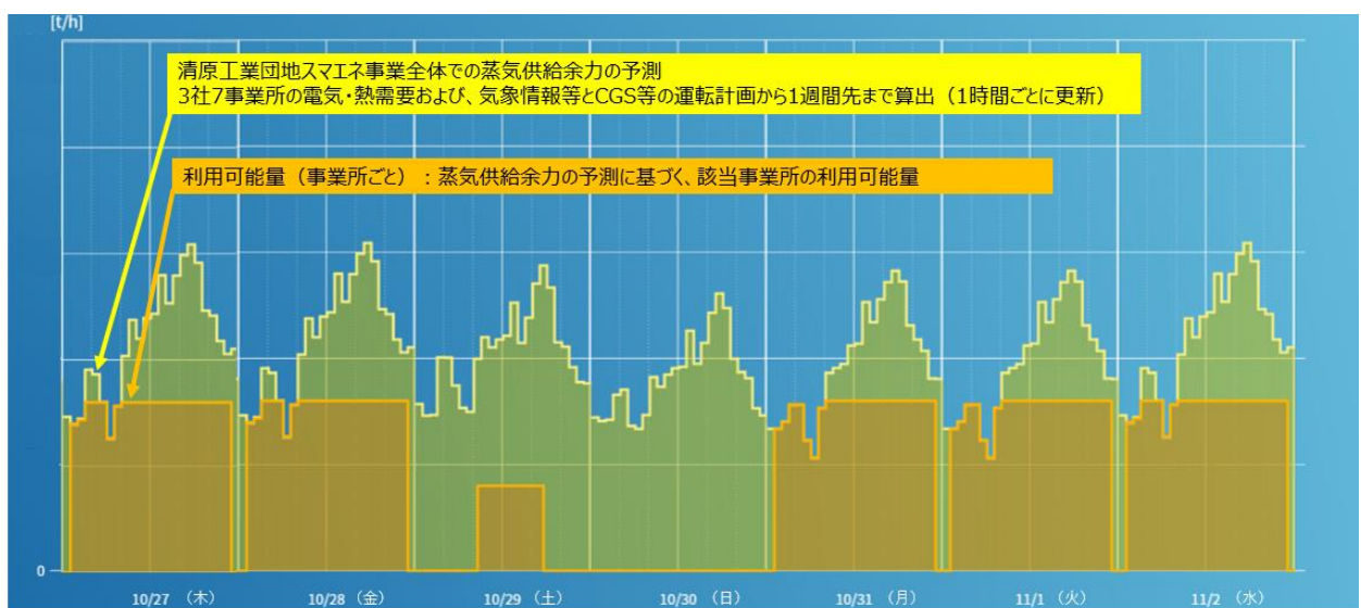
各事業所で確認可能な蒸気供給余力および利用可能量の予測イメージ
