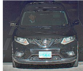
新開発の CMOS センサーによる撮影例（124dB 程度の環境下）
