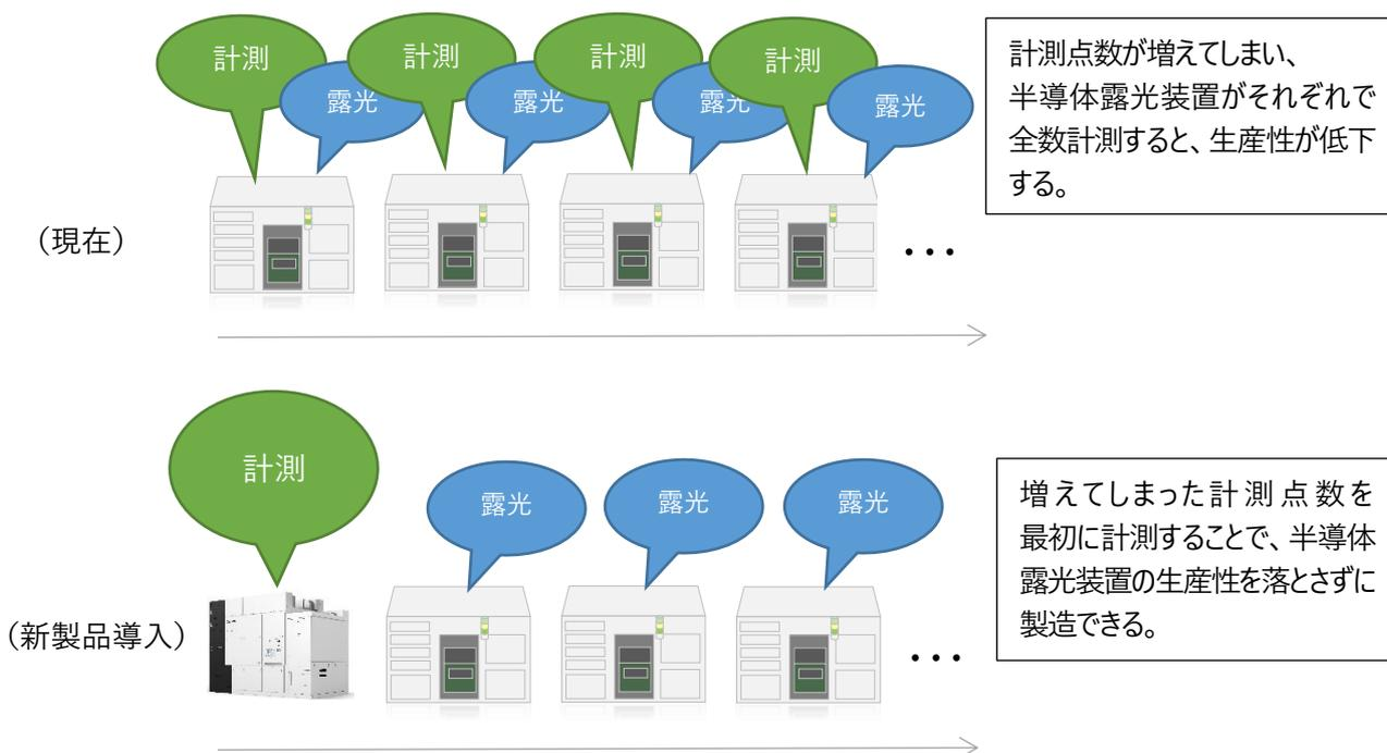
100～700点という多数のアライメント計測が必要な先端半導体製造の場合、“MS-001”を導入すると、半導体露光装置の生産性を向上することができ、お客様のCoO削減に貢献することが可能。
