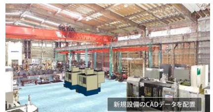
工場点群データと導入予定の設備 CAD データによる設備配置シミュレーション (展示協力：大豊精機株式会社)
