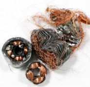
キヤノンエコロジーインダストリーが回収した複合機から取り出した鉄 （左：銅が付いた状態の鉄、右：純度 99%に分別した鉄）
