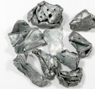
キヤノンエコロジーインダストリーが回収した複合機から取り出した鉄 （左：銅が付いた状態の鉄、右：純度 99%に分別した鉄）
