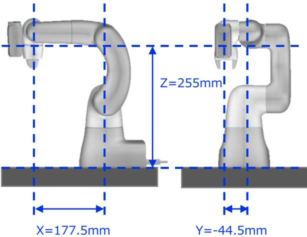
左図のような位置にロボットが移動すればOK。
