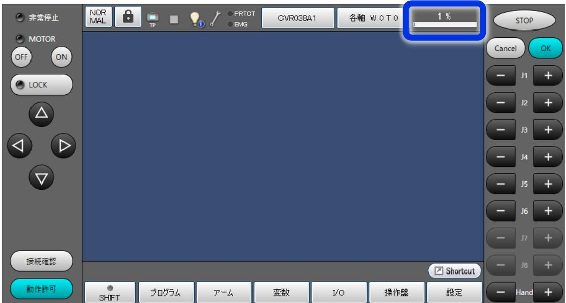
2 速度設定画面が開くので [SPEED] のバー部分を押して、任意の速度に変更し [OK] ボタンを押す。
