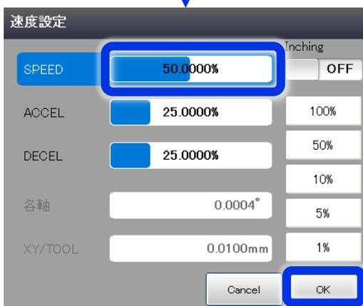
●方法②. フローチャートのロボット動作パーツの速度設定を変更する
