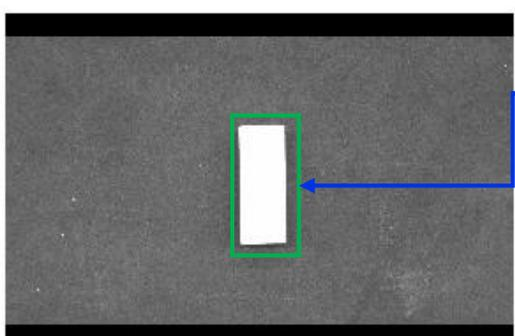
正しく認識できていると左図のようにワークが緑色枠で囲われます。
