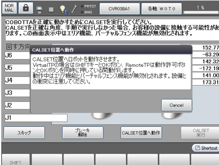
ロボットを動かすには接続ソフトによってボタンの組み合わせが異なります。
