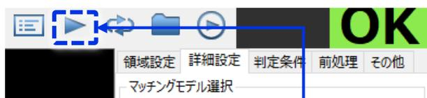
画面上部にある [手動トリガ] ボタンを押して、認識が上手くできているかを確認します。
