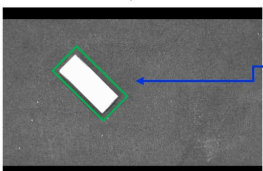
続いてワークを手で動かしてから先ほどと同じように [手動トリガ] ボタンを押して、正しく認識できるかを確認します。
