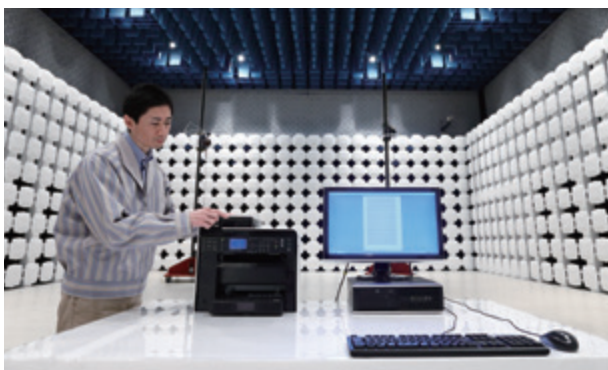
電波暗室における製品の放射電波測定
