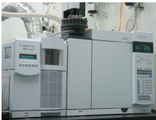
製品から放出される化学物質を測定するガスクロマトグラフ質量分析計
