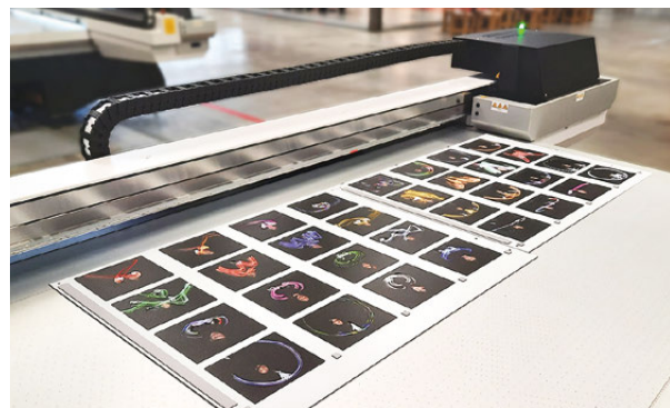
隆起印刷技術を活用した作品「FUGA」の制作風景
