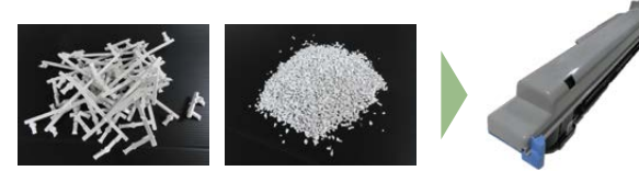
端材 粉碎材 ドラムケース プラスチック端材を活用した100%*リサイクル材ドラムケース ※ カラーマスターバッジを除く
