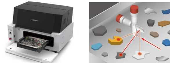
(左) ラマンプラスチックアナライザー TR-A100 (右) キヤノンの高精度ガルバノスキャナーにより、トレイ上に並べた複数のプラスチック片ヘレーザを順次照射、その際に生じる材質特有のラマン散乱光を分光解析することで材質を判別
