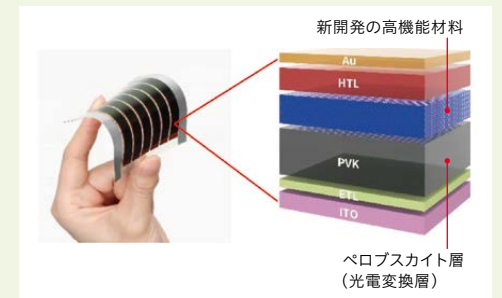
左：ペロブスカイト太陽電池 右：新開発の高機能材料を積層したペロブスカイト太陽電池の構造
