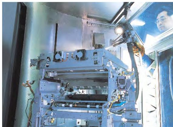
ドライアイス洗浄装置による回収製品の洗浄
