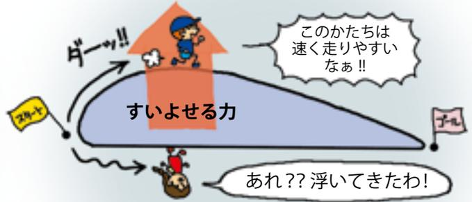
つばさの上側は下側よりも空気の流れが速くなる。だから上側に“すいよせる力”が生まれる。この力がつばさを持ち上げるんだよ。
