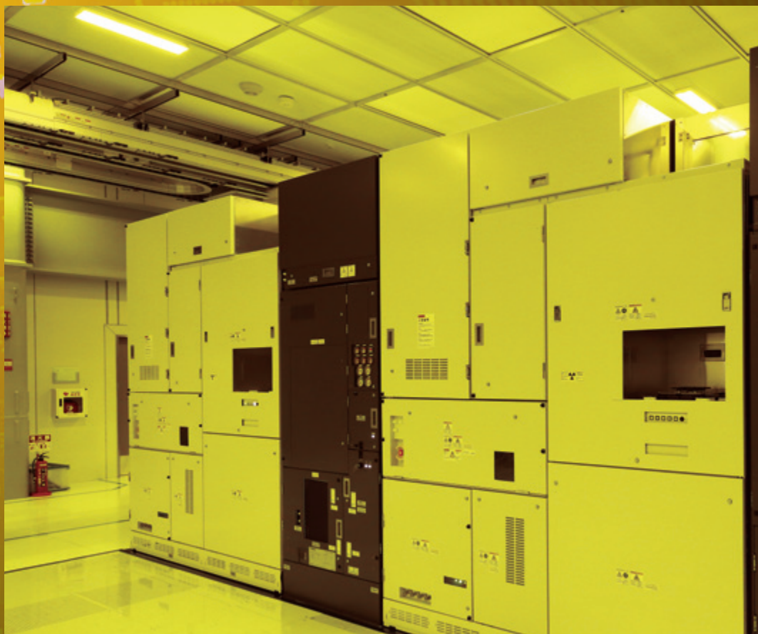
キオクシア株式会社 四日市工場で稼働するキヤノンのナノインプリント半導体製造装置
