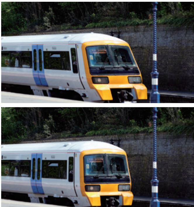
上：ローリングシャッター方式での撮影 下：グローバルシャッター方式での撮影
