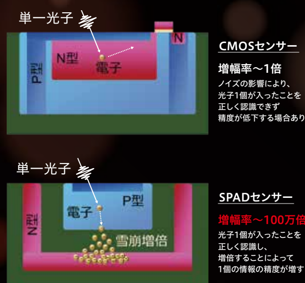
CMOSセンサーとSPADセンサーの比較
