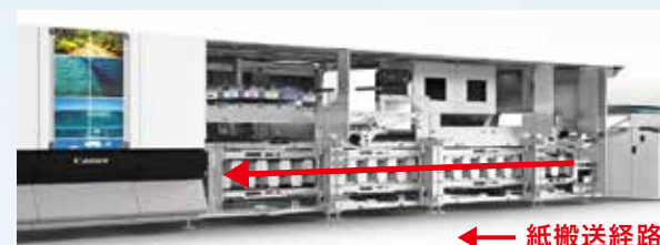
ProStream1000機械内部(非接触インク乾燥技術)
