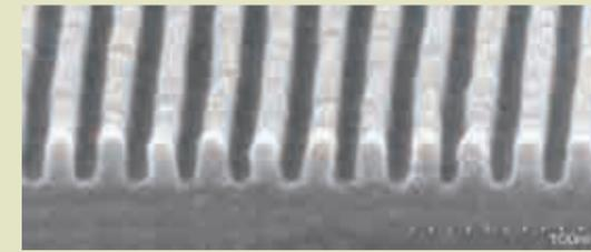
ナノインプリントリソグラフィで形成した線幅14nmのライン&スペースパターン
