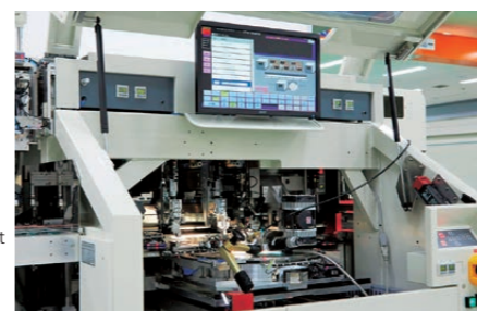
Die Die Bonder von Canon Machinery zeichnen sich durch hohe Geschwindigkeit und hohe Präzision aus
