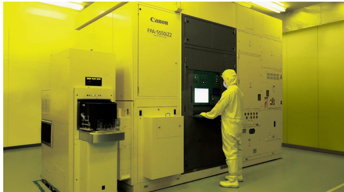
i-Line Stepper werden für die Herstellung von Speichern, Bildsensoren und mehr verwendet
