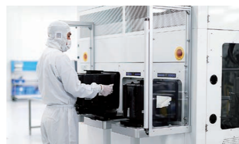
Die Sputteranlage von Canon ANELVA scheidet gleichmäßige Schichten im Nanobereich in einem Vakuum ab
