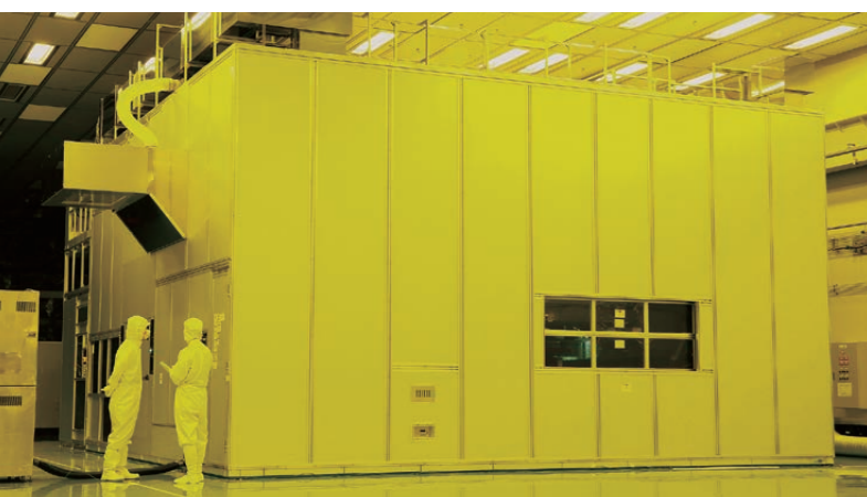
Canon Flat Panel Display (FPD)-Lithografieanlagen belichten Schaltkreise auf Glassubstrate
